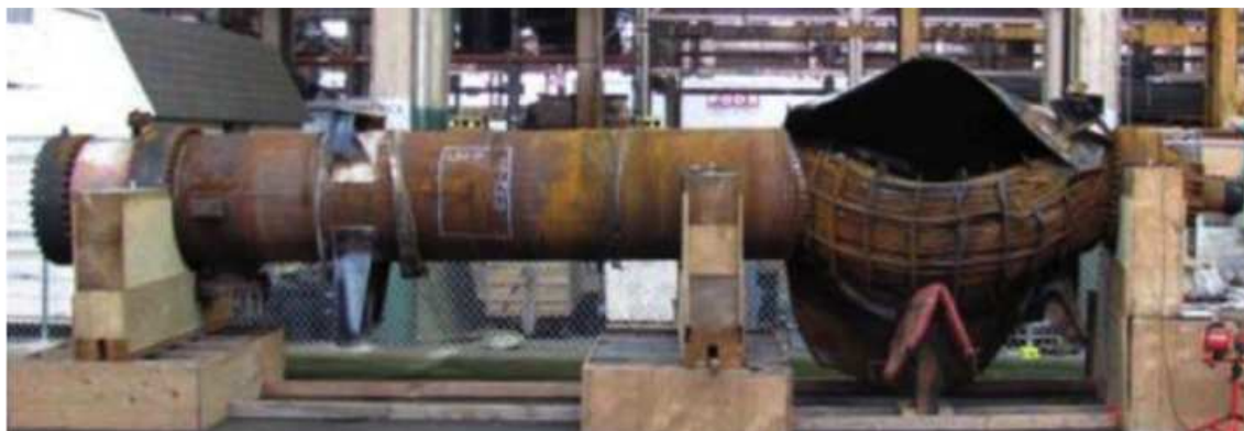
Figura 11 – Trocador de calor da refinaria Tesoro em que ocorreu a falha. Nesta observa-se a ruptura do casco do trocador à direita. Fonte: [32]
